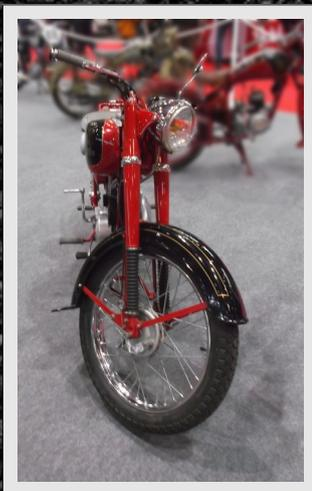
*Ce modèle très répandu dans les années 50, remplace avantageusement la série des S3 dans la catégorie des vélomoteurs<sup>(\*)</sup>. Plus puissant, avec 3 puis 4 vitesses au pied, il est entièrement suspendu.*
