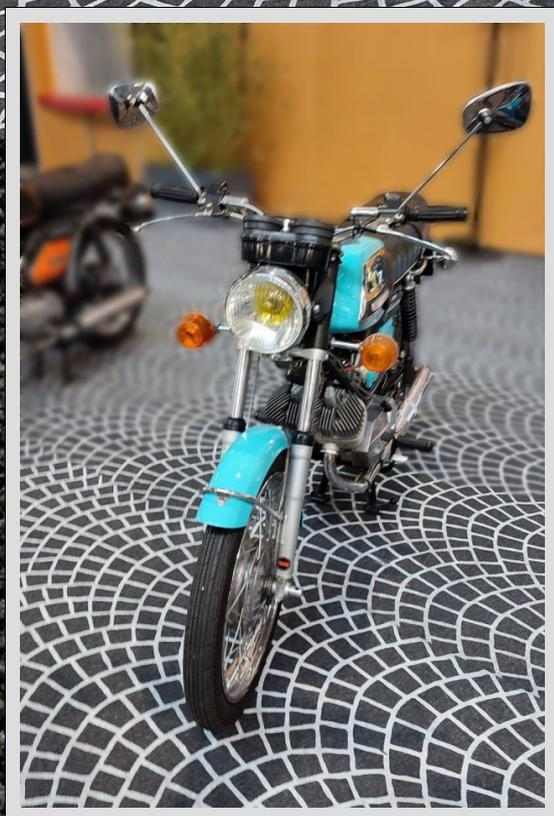
*Le support de plaque police est allongé - Le bras oscillant est rallongé de 15 mm – La LT1 est équipée de nouvelles jantes en 1.85 à la place des 1.60. Dans ce premier modèle, les cylindres restent ronds.*
