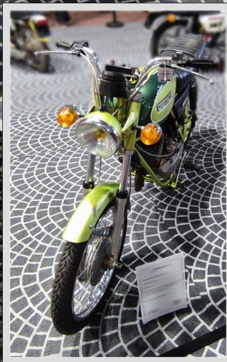
*Prototype destiné à l'armée française, équipé d'un mono-cylindre de 118cc et de l'injection électronique.*
