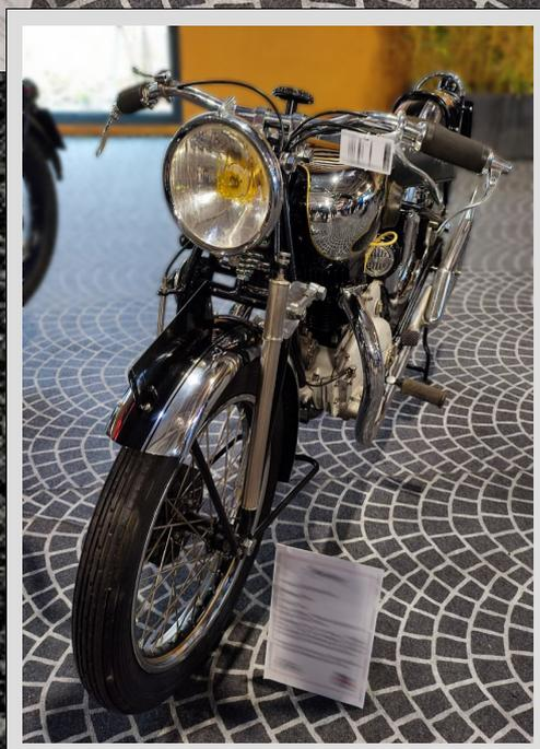
*MOTOBÉCANE lance son premier « compétition-client » avec cette prestigieuse moto de compétition et 130 Km/h grâce à une culasse à 4 soupapes et un piston haute compression.*
