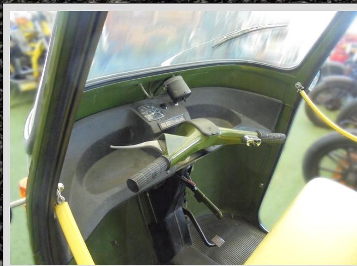
*Les initiales MP signifient « moteur arrière ». C'est la première fois que le moteur est déplacé de la cabine et repris sous le corps, afin de réduire les vibrations dans la cabine et d'améliorer le confort du conducteur. Le modèle MPV est équipé d'un volant en lieu et place du guidon.*
